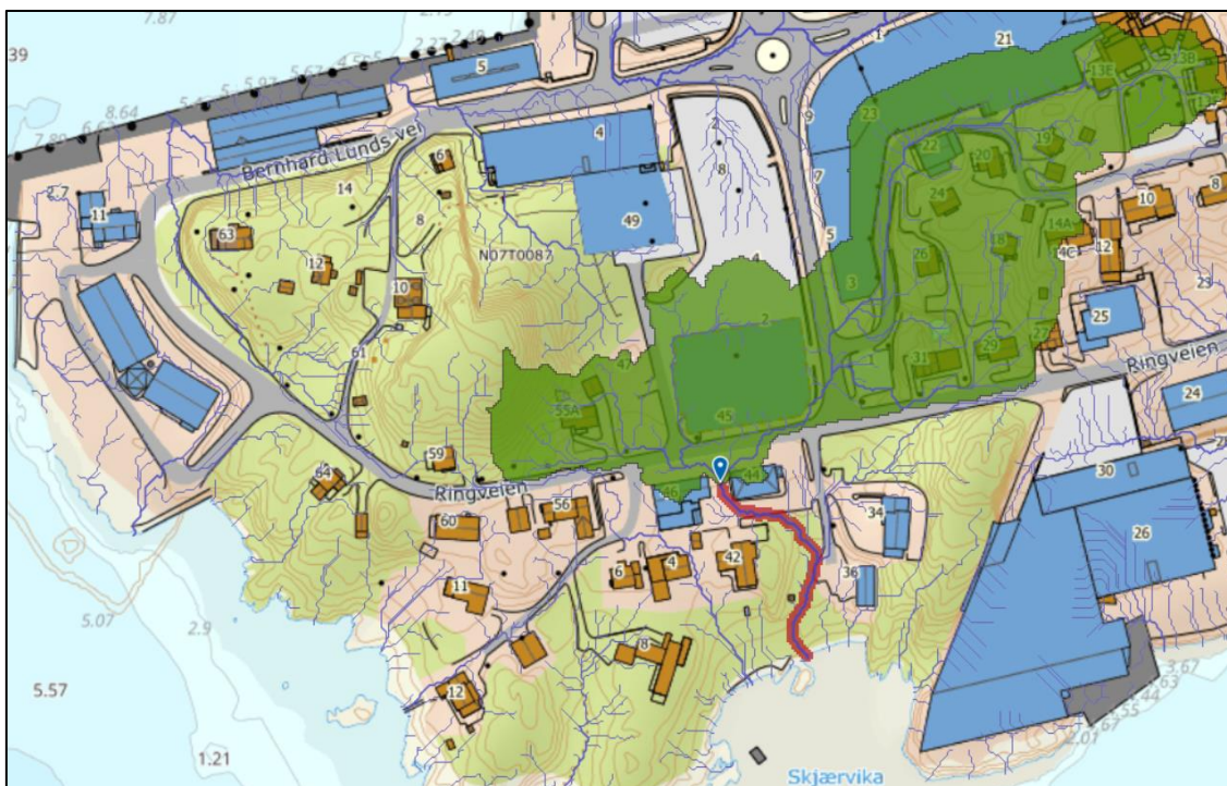
Figur 1: Skjermdump fra Scalgo Live. Eksisterende overvannssituasjon. Avrenningslinjer (lilla) illustrerer hvor overvann vil renne på terreng. Nedbørsfelt markert med grønt utgjør et område på 2,47 ha og har avrenning til sjø via forsenkning i terrenget markert med rødt.
