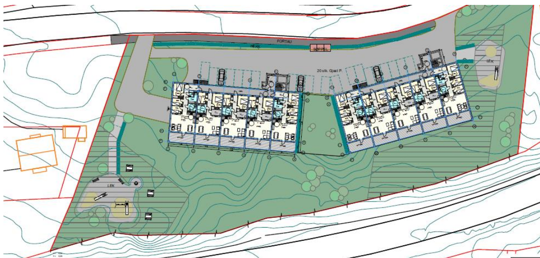
Oppsatt støyskjerm langs fronten av uteoppholdsarealet ved formålsområde BBB1
