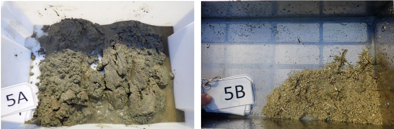
Figur 12. Bilde av sedimentet tatt opp ved prøvepunkt 5. A representerer sediment før vask/siling og B representerer vasket/silt prøve.
