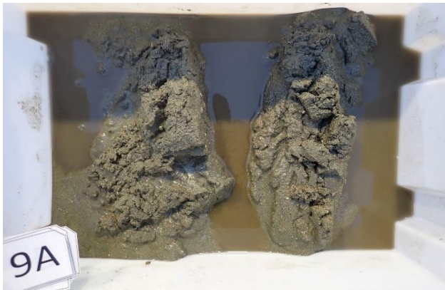
Figur 16. Bilde av sedimentet tatt opp ved prøvepunkt 9. A representerer sediment før vask/siling og B representerer vasket/silt prøve.
