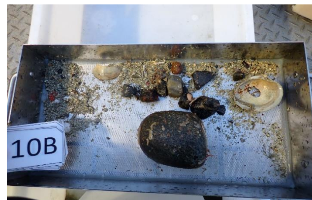
Figur 17. Bilde av sedimentet tatt opp ved prøvepunkt 10. A representerer sediment før vask/siling og B representerer vasket/silt prøve.
