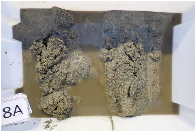
Figur 15. Bilde av sedimentet tatt opp ved prøvepunkt 8. A representerer sediment før vask/siling og B representerer vasket/silt prøve.
