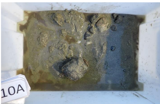
Figur 17. Bilde av sedimentet tatt opp ved prøvepunkt 10. A representerer sediment før vask/siling og B representerer vasket/silt prøve.
