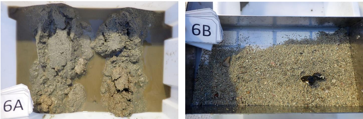
Figur 13. Bilde av sedimentet tatt opp ved prøvepunkt 6. A representerer sediment før vask/siling og B representerer vasket/silt prøve.
