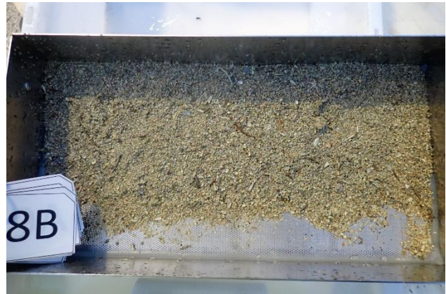
Figur 15. Bilde av sedimentet tatt opp ved prøvepunkt 8. A representerer sediment før vask/siling og B representerer vasket/silt prøve.
