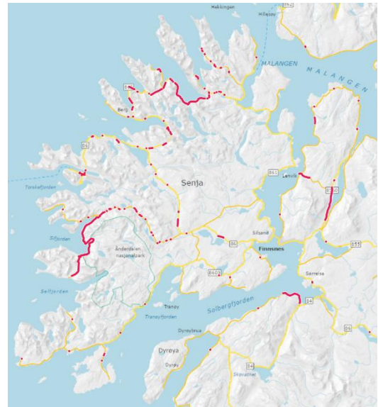
Figur 8: Oversikt over skred ved veg i Senja kommune. Etter 01.01.2015. Kilde vegkart.no Objekttipe skred 445.
