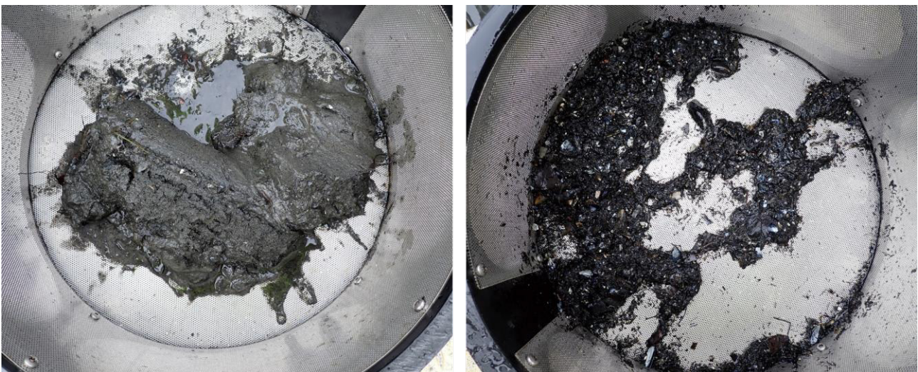
Figur 7-3: Prøvemateriale fra stasjon F6 med usiktet innhold til venstre siktet innhold til høyre. Foto: Multiconsult AS.
