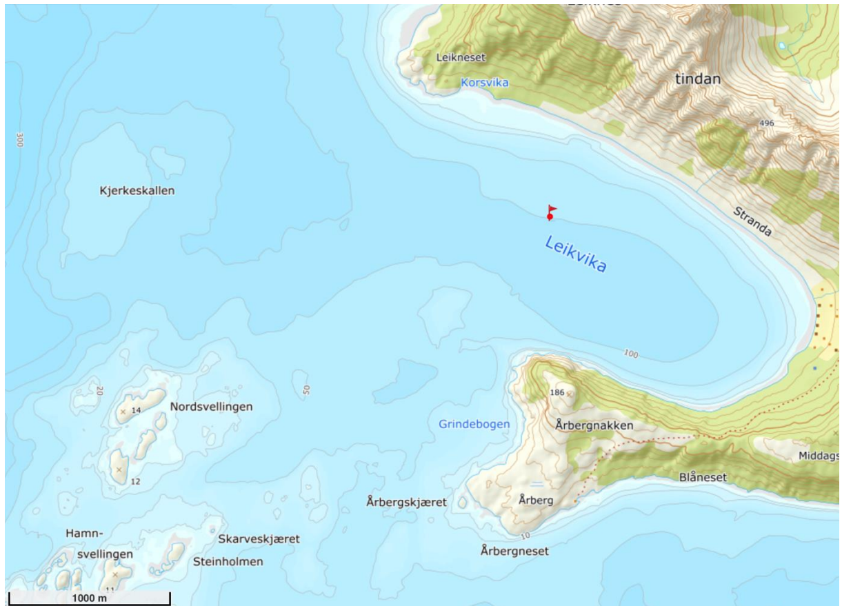
Figur 2.2: Kartutsnitt med dybdekoter i anleggsområdet [6]. Strømmålerriggens posisjon, markert med et rødt flagg, er vist i ft. anleggets planlagt senterpunkt (rød prikk).
