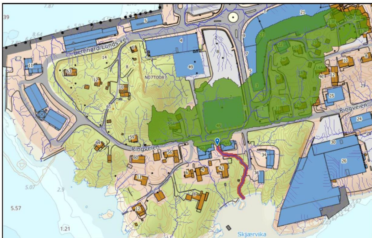
III 5.8: Hentet fra VAO-rammeplan. Eksisterende overvannssituasjon. Avrenningslinjer (lilla) illustrerer hvor overvann vil renne på terreng. Nedbørsfelt markert med grønt utgjør et område på 2,47 ha og har avrenning til sjø via forsinking i terrenget markert med rødt.
